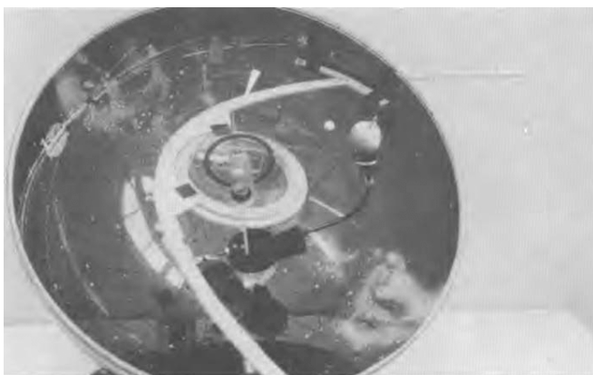
Abb.2 Kometenbahn, eingesetzt in das Baader Planetarium
