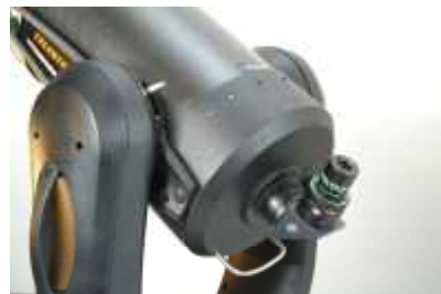
Am Celestron C8" GPS: Maxbright-Zenit Spiegel mit 35mm Öffnung, daher ohne Vignettierung – bestehend aus Baader T-Adapter (#21), T-2 Zenit Spiegel (#1a), ClickLock® (#8)
